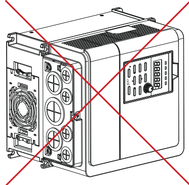
с. Поперечная установка
